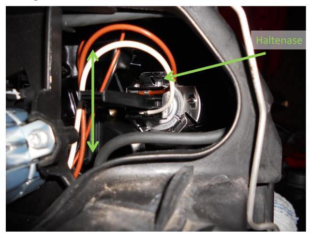
6. Austausch Standlicht: Die Lampe des Standlichts ist etwas schwerer zugänglich. Für etwas mehr Platz im Scheinwerfer empfiehlt sich der Ausbau des Zusatzfernlichts oder wenigstens die Demontage des Steckers für das Zusatzfernlicht.
