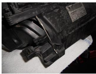
4. Von hier hat man Zugriff auf den Xenonbrenner, das Standlicht und das Zusatzfernlicht. Der Blinker und die Seitenmarkierungsleuchte sind über eine separate runde Öffnung an der Seite zu erreichen.
