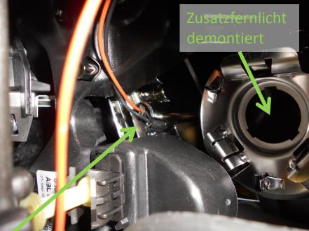
6. Austausch Standlicht: Die Lampenfassung kann einfach, wie in der Betriebsanleitung erklärt, am Kabel aus der Halterung gezogen werden. Beim anschließenden Zusammenbau darauf achten, dass die Fassung wieder komplett im Halter sitzt. Das Klicken beim einrasten ist deutlich hörbar.
