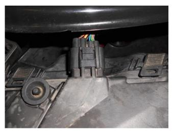
3. Anschließend die Abdeckkappe auf der Rückseite vom Scheinwerfer lösen. Sie ist mit zwei Halteclips und einer seitlichen Metallklammer befestigt.
